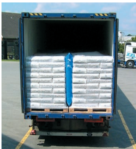
Formschlüssige Sicherung zu allen Seiten
