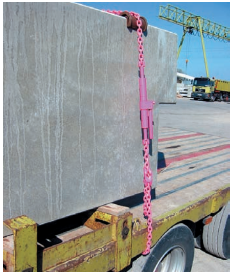
Niederzurren mit Spannketten
