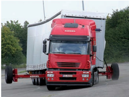
Prüfung der Aufbaufestigkeiten durch einen Fahrversuch Bild Kogel
