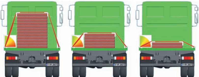
Niederzurren mit Spannketten
