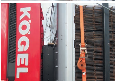
Formschlüssige Sicherung nach vorne durch Anliegenlassen der Ladung an Rungen oder an der Stirnwand
