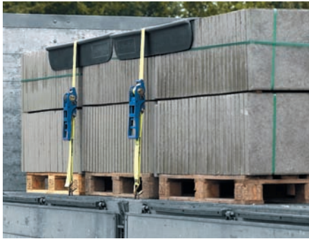
Niederzurren mit Spanngurten
