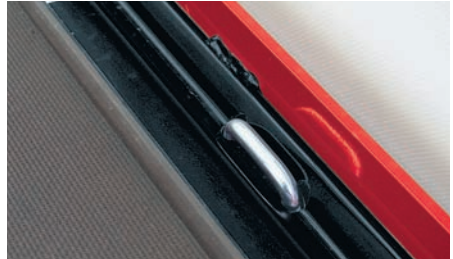
Palettenanschlagsleiste mit Zurrmöglichkeit
