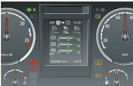
Die elektronische Überwachung in modernen Lkw hilft bei der Fehlersuche Bild Scania
